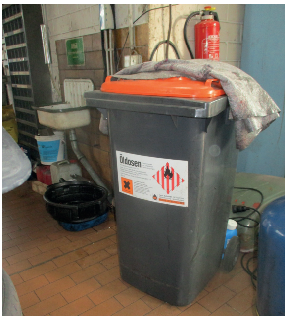
Bild 3: Sammelbehälter für ölhaltige Betriebsmittel.
